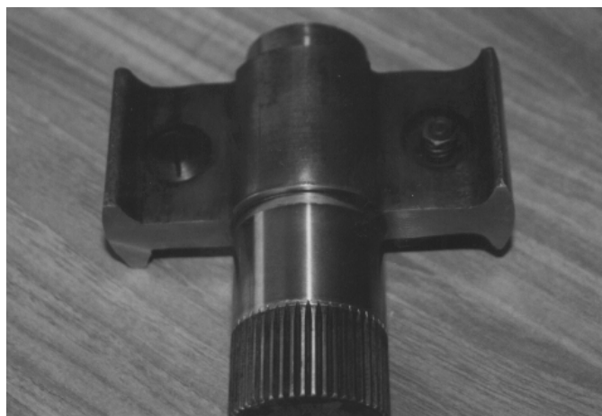
شکل ۲: پره ضربه گیر بازیابی شده به روش فلزپاشی
