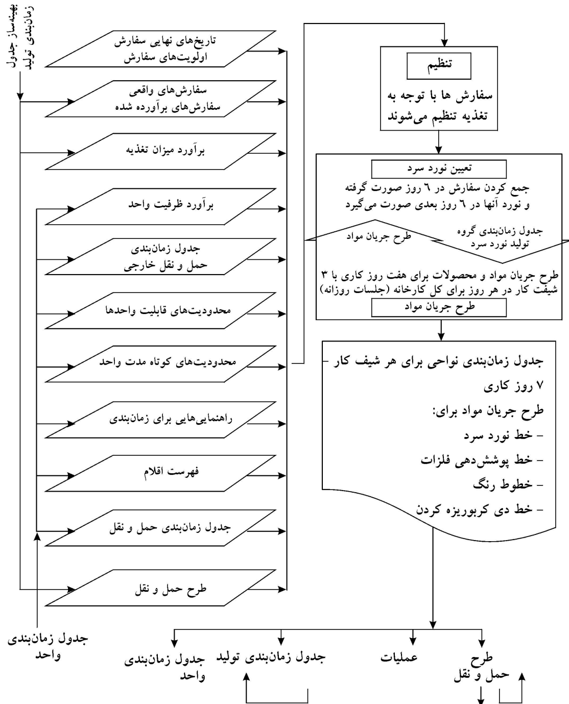
شکل ۶: سطح زمان بندی پیشرفته، ۱۰۰۰ گروه محصول، برآورد برای ۳ تا ۵ هفته، استراحت روزانه. (برای محصولات دست ساز، برآورد برای ۳ تا ۵ هفته، استراحت هفتگی).
