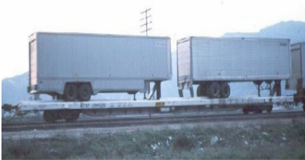
شکل (۴). تریلر روی واگن مسطح با واگن‌های دوقلو [۲۴]
